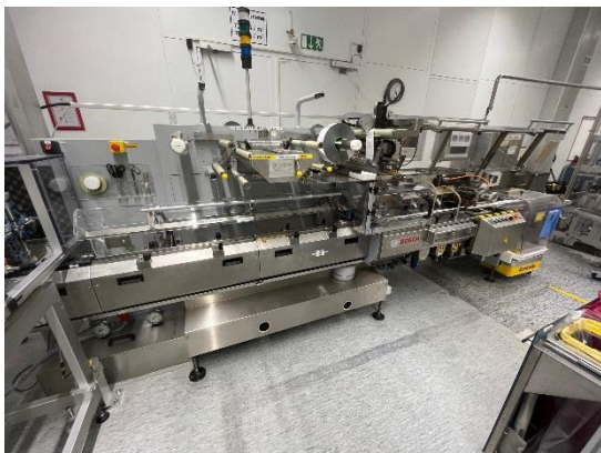
Bosch (SIG) / Jakob & Wienmeier / OCS / Seidenader / Pester blister packing line
